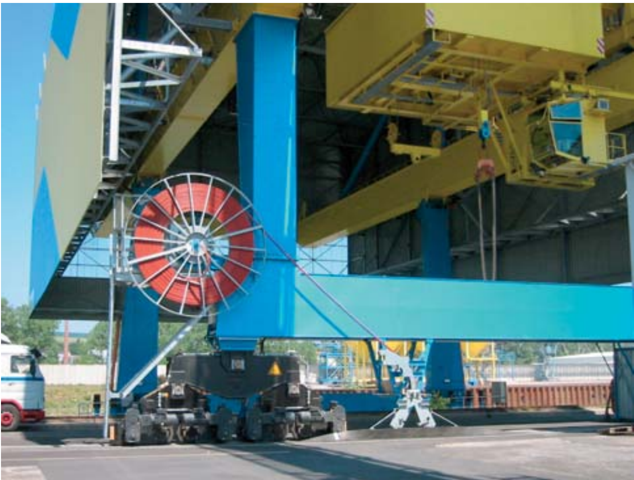
Кабельный барабан с электроприводом LTM 18/38 H4K240-108/МК 78-В на комбинированном кране в порту Andernach, используемый для намотки кабеля 20 кВ. Приведение в действие посредством двигателя трехфазного тока через электромагнитную муфту
